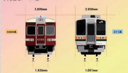
車両幅とレール幅
