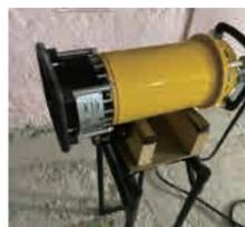
非破壊検査(X線探査)
